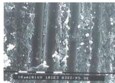
Fig. 2 - Fibra inmersa en matriz cementicia aditivada
